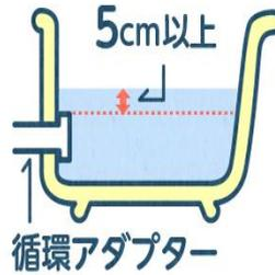
水位を循環アダプタより高くしておくことで、給湯器が自動的に浴槽の水を循環させ凍結を予防します！
